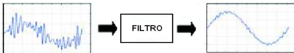
Fig. 2. Simulación de filtrado de señales temblorosas en tiempo real.
